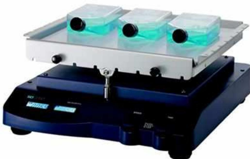
L'agitateur à balancement est adapté pour les applications de mélange dans les champs divers notamment, la coloration de gel et la décoloration, les lavages, les hybridisations, les précipitations immunitaires et les encres de l'ouest.
